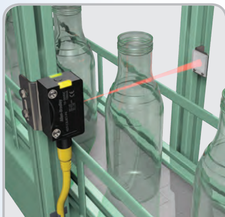
瓶子感測 - 由於採用的特殊光學技術，42JT 透明物件感測器能可靠地偵測透明的瓶子。
