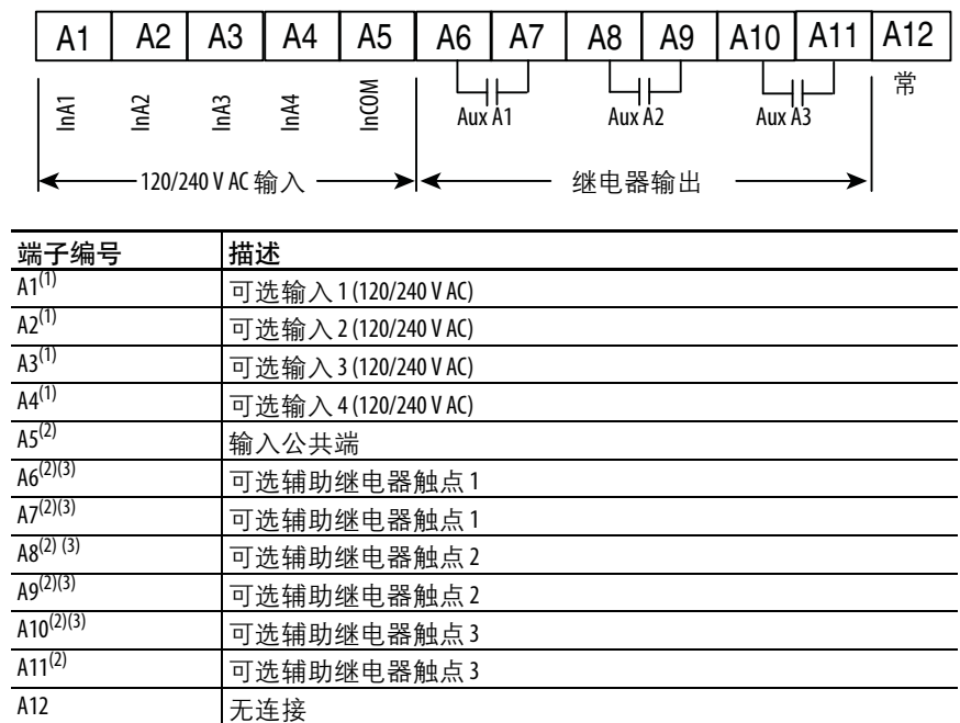
图 104 - 可选数字量 I/O 模块端子标识
